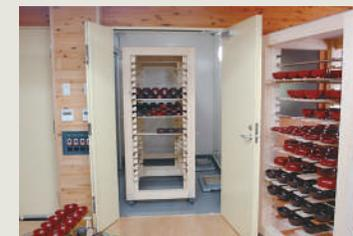
増設した大型漆風呂。漆は特定の温度と湿度が一定に保たれる漆風呂に入れて、硬化、養生させます。
