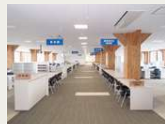
木立をイメージする大断面集成材の柱
