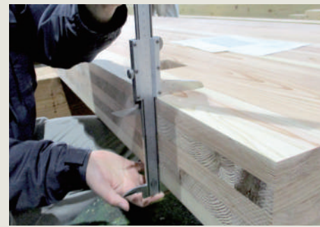
施設建設に活用されたCLTパネル
